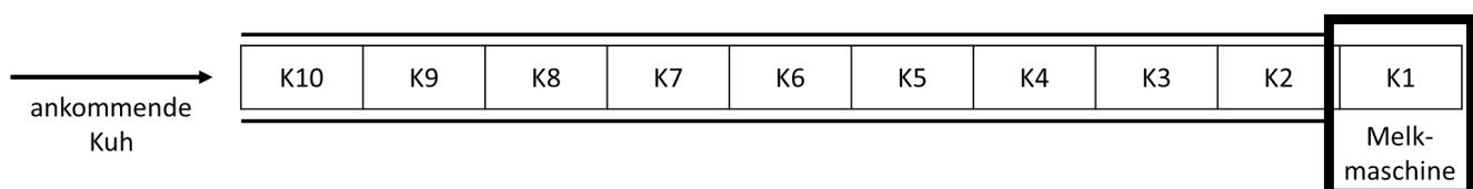
Jede ankommende Kuh wird mit der Operation ENQUEUE("name") der Warteschlange der Melkmaschine hinzugefügt. Ist eine Kuh fertig gemolken, wird sie mit der Operation DEQUEUE() aus der Warteschlange entfernt. Folgender Algorithmus zeigt einen Melkvorgang zu einem bestimmten Zeitpunkt.
